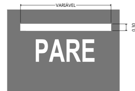
DETALHE TÍPICO SINALIZAÇÃO SEM ESCALA
